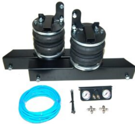
Układ pneumatyczny dwuobwodowy
